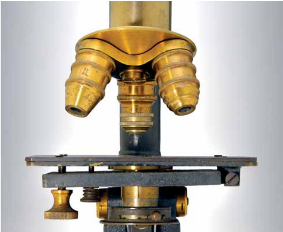
Nahaufnahme eines Mikroskops mit Mohlschem Tisch.
